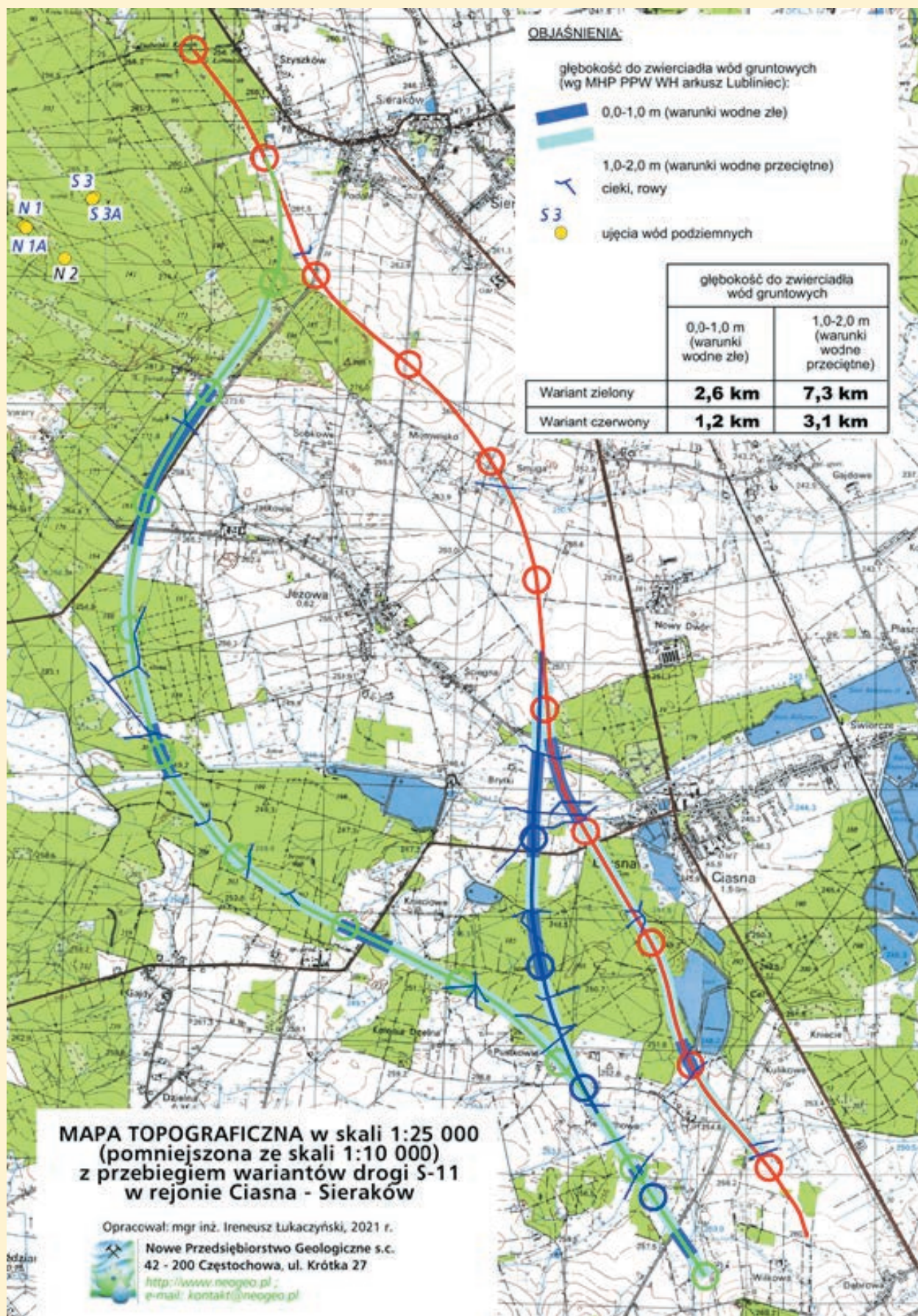
Mapa nr 2 Topograficzna, głębokość wody gruntowej
