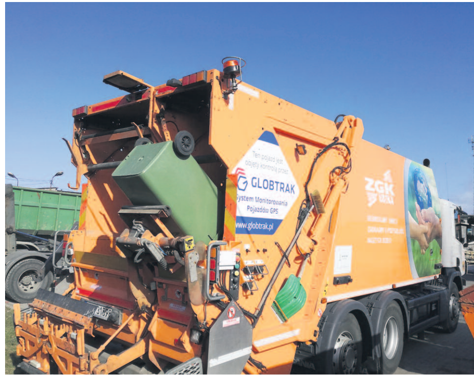
■ Z-2-KOMOROWA ŚMIECIARKA Z WAGĄ DYNAMICZNĄ, OBSŁUGUJĄCA TEREN MIASTA USTKA
