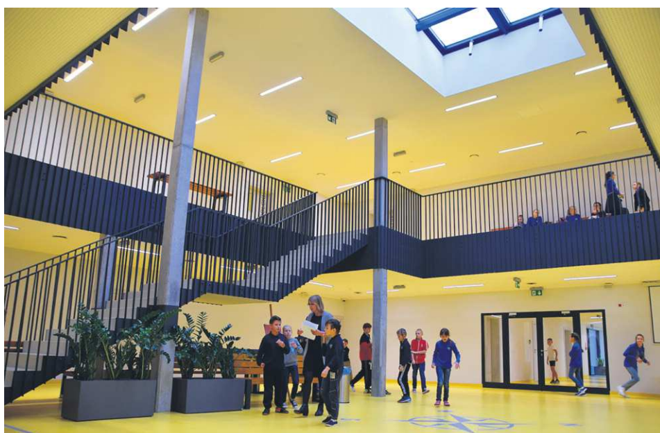
ENERGOOSZCZĘDNE OŚWIETLENIE LED-OWE I ŚWIETLIK ZAPEWNIĄ MINIMALNE ZUŻYCIE ENERGII
