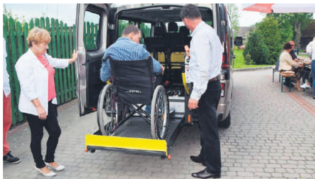
Samochód wyposażony w windę umożliwiającą transport niepełnosprawnych na wózkach
