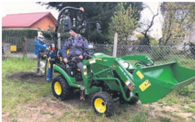
Ciągnik ułatwia np. wykonywanie otworów pod nasadzenia drzew
