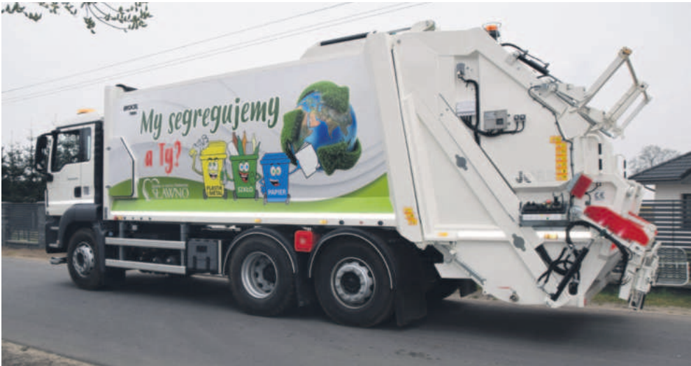
Śmieciarka dwukomorowa pozwala podczas jednego kursu odebrać dwie różne frakcje odpadów
