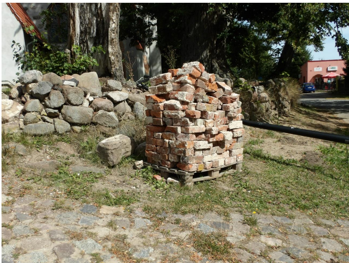
Fot. 14. Złożone na palecie cegły z powalonej części bramy. Cegły w dobrym stanie zachowania. Wymagają oczyszczenia, dezynfekcji, odsolenia i wzmocnienia.
