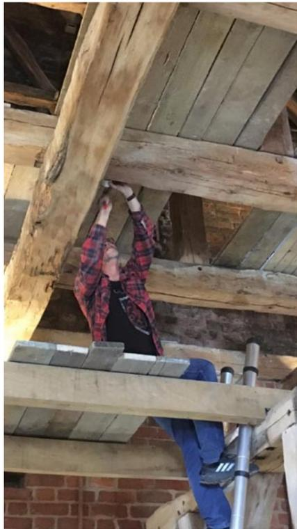
Probenentnahme aus der Dachstuhlkonstruktion der Kirche
